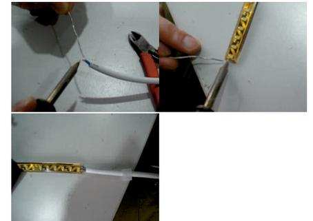
8. Kleber in Silikonendkappe einfüllen und auf Flex Strip schieben. Überflüssigen Kleber entfernen.
