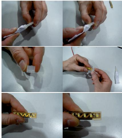
4. Kabelseitig Silikon im Bereich der Lötunkte lösen. Leiterbahnen nicht durchtrennen. Lötunkte säubern
