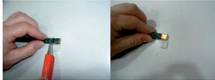
3. Endkappe (Silikon) **ohne** Kabel mit Kleber füllen und auf Stripende schieben. Überflüssigen Kleber entfernen
